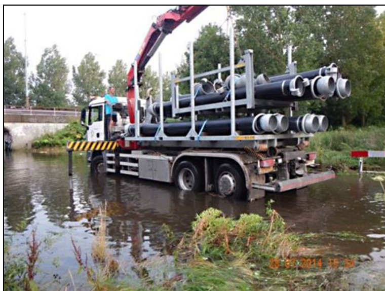
Figuur 8 : Een vrachtauto met leidingen voor een noodbemaling
