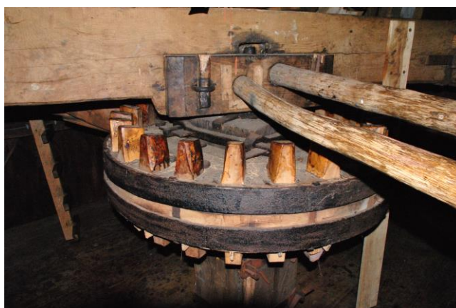
Een bovenbonkelaar, de bus-of ijzerbalk met het taplager, de busdeur en twee poortstokken.
