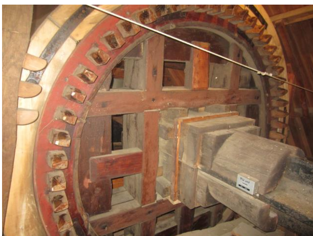
Een bovenwiel met extra stutten tussen kruisarmen en plooistukken. De vulstukken zijn deels afgerond.
