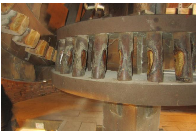
Een taps rondsel ('wieg') kost vanwege de schuine stand van het bovenwiel minder ruimte in de kap.
