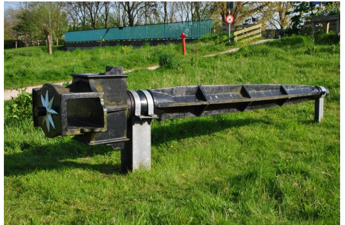
Een gietijzeren bovenas. In de askop de roegaten. Voorop de walpen. Op de staart van de as versterkingsribben.
