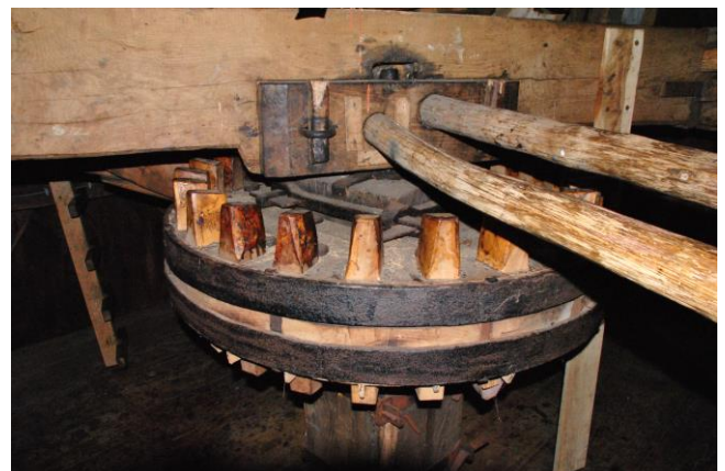
Een bovenbonkelaar, de bus-of ijzerbalk met het taplager, de busdeur en twee poortstokken.
