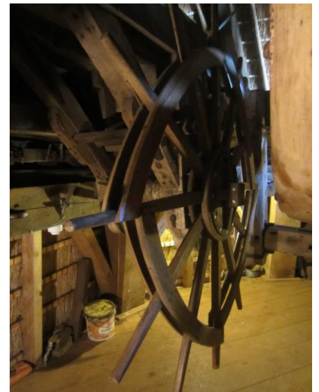
Het kruiwiel van een binnenkruier
