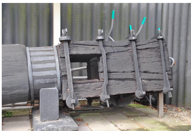
De houten askop met roegaten, knuppelstroppen en bronzen schenen rond de hals.
