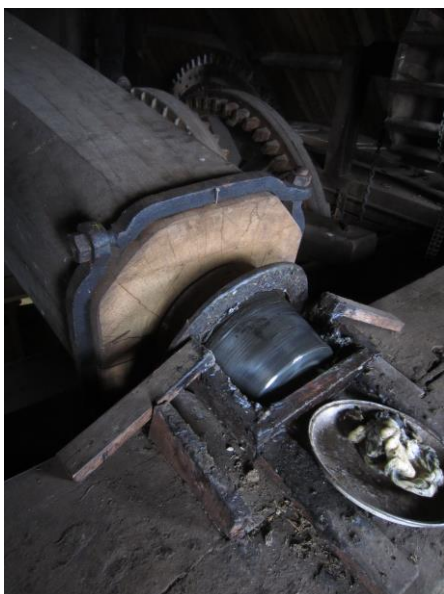
Een houten as en penlager. Om de pen een muts.
