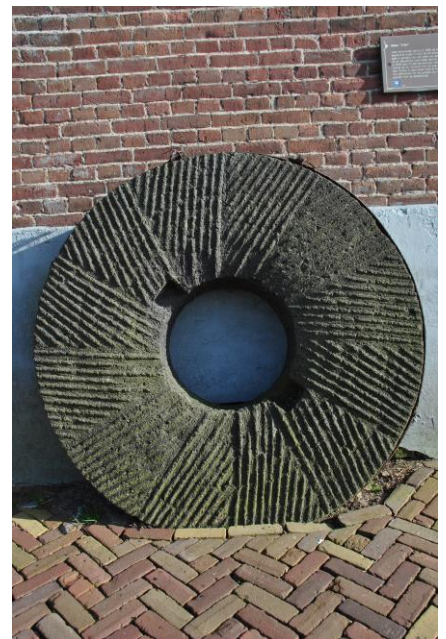
Een blauwe steen met pandscherpsel. Een looper: er zijn gaten voor de rijs.
