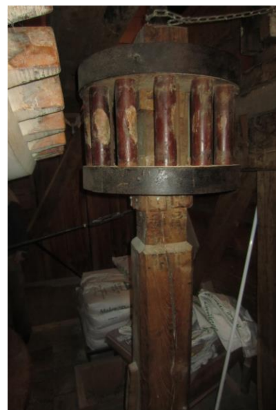
Een steenrondsel met lange steenspil van de achtermolen.
