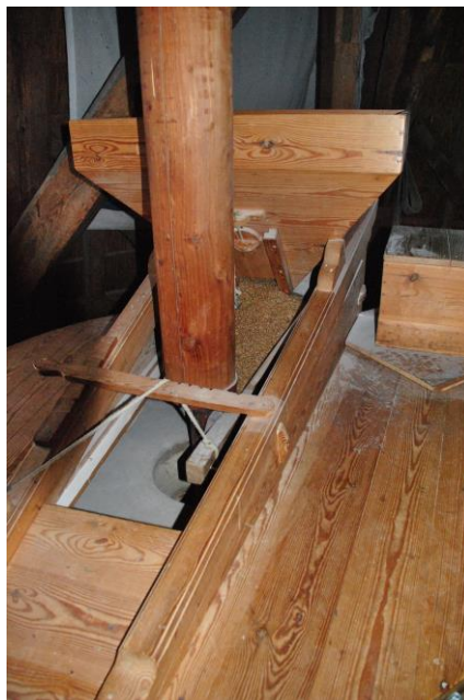
Het kaar, de schuddebak met aanslag en hanger en de steenspil.
