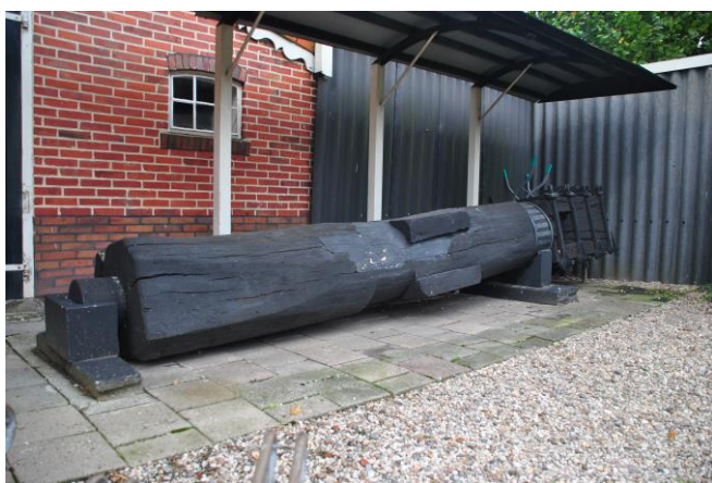
Een houten molenas met vulstukken voor de bevestiging van het bovenwiel. Links een muts om de pen.
