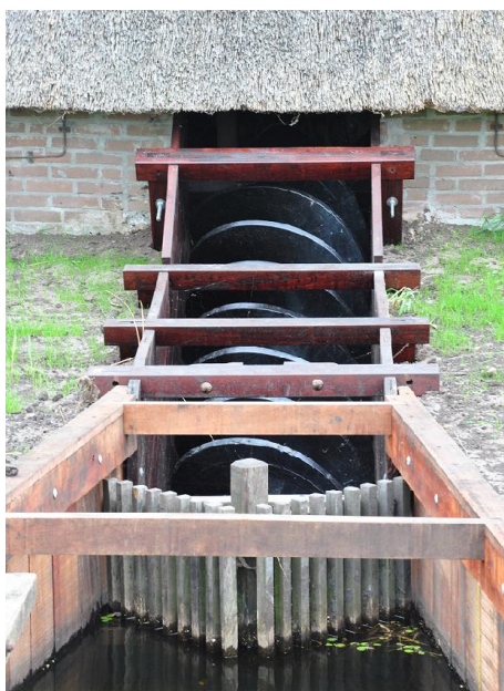
Een houten vijzel met krooshek. Het dek van de vijzelbak is nog niet aangebracht.
