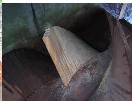
Onder: in een houten vijzel wordt een nieuwe schroefgang aangebracht. Deze wordt opgebouwd uit 'duigen'.
