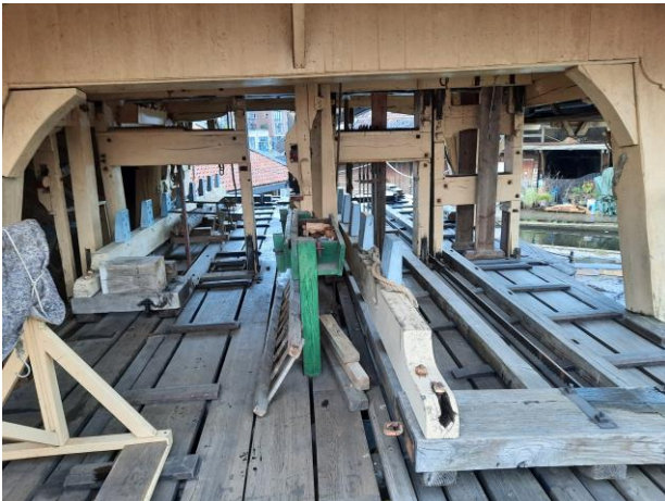
De zaagvloer gezien van achter de zaagramen. Er zijn twee zaagsleden en naast elke slede een schulpvloer. Rechts wordt geschulpt op het kleine raam, links gebeurt het schulpen in het voorraam.
