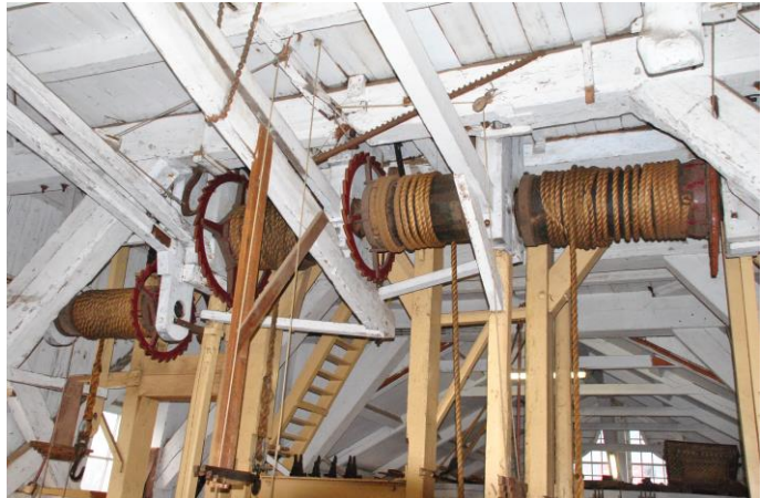
De winderij. De tweede rol van links is voor het luien van de zaagsleden. De Heesterboom - Leiden
