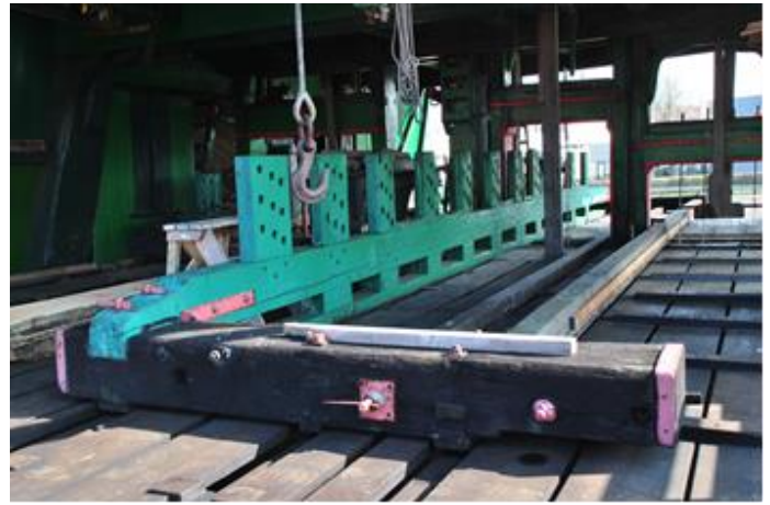
Een zaagslede gezien vanaf het achtereind. We zien twee leggers en boven de linker legger het pollenstuk met pollen. Vooraan het verlengde sleehoofd. Het verlengde deel duwt planken door het kleine of schulpraam.
