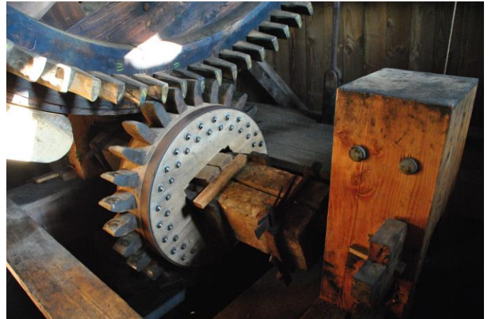
In een paltrokmolen wordt de krukas direct aangedreven vanaf het bovenwiel. Het krukaswiel is hier uitgevoerd als varkenswiel. De Held Jozua - Zaandam
