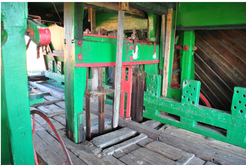
Het voorraam met rechts een aantal ingespannen zagen en links vier zagen om te schulpen.
