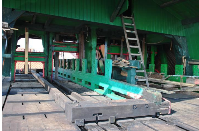
De zaagvloer van een paltrok. Er zijn drie zaagframes en twee zaagsleden. Het kleine raam links is het schulpraam.
