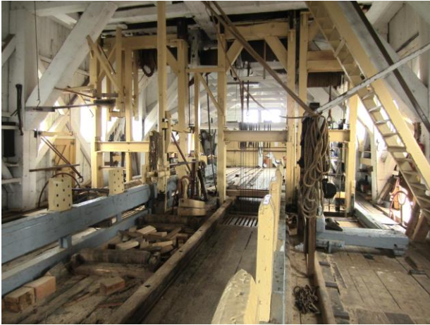
De zaagvloer van een bovenkruier zaagmolen: er zijn drie zaagframes en drie zaagsleden.
