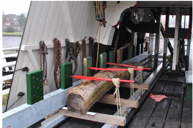
De stam ligt op schotels op de slede en is met balkijzers en touwen vastgezet. De Eenhoorn - Haarlem
