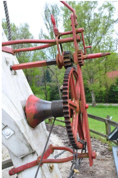
Een kruilier met conische liertrommel en stalen kruidraad. De overbrenging is indirect, waardoor het lichter – maar langzamer – kruit.
