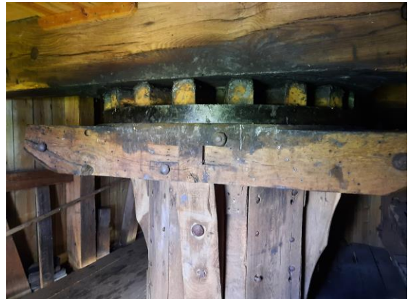
Kruineuten op de bovenzetel vergemakkelijken het smeren ervan aanzienlijk
