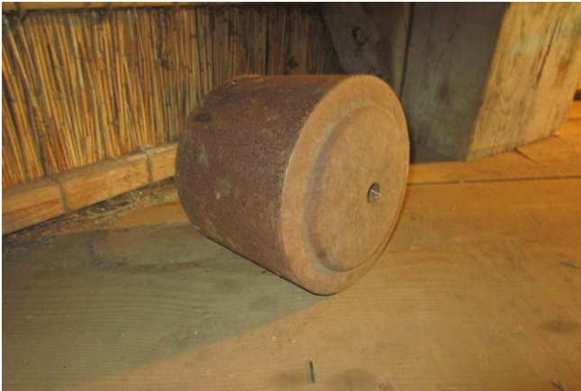
Een gietijzeren kruise. Een kruise is enigszins conisch om de cirkelvormige kruisevloer te kunnen volgen. De buitenzijde van de rol is bol: deze raakt aan de rollenwagen en dient gesmeerd te worden.
