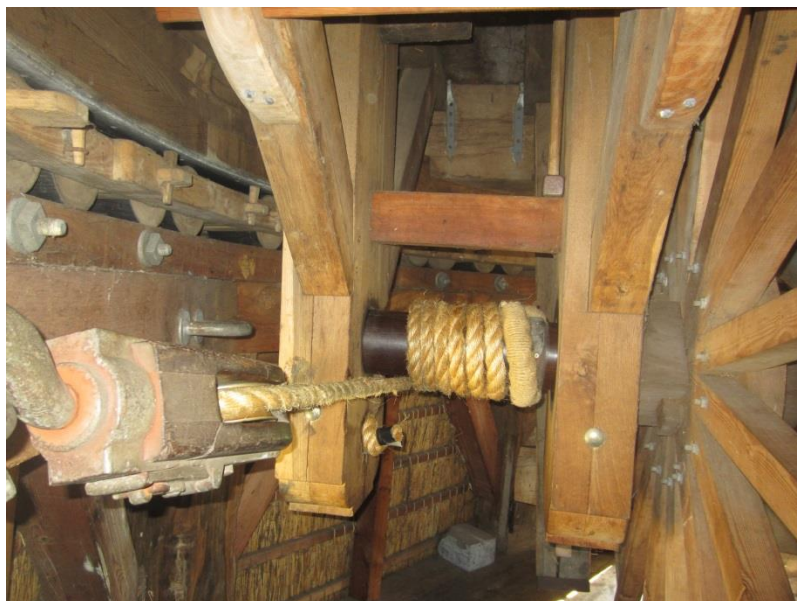
De kruias (windas) hangt tussen de kruipollen. Rechts het kruiwiel, links de kruireep met blok en haak. De reep ligt hier voor krimpemd kruien. In de kruivloer is een kruikram zichtbaar.
