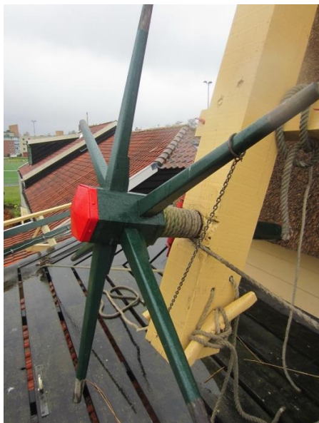
Een kruihaspel met zes spaken. Bij iets grotere haspels is soms een gording aangebracht.
