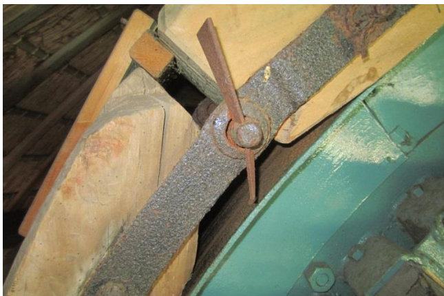
Afb.3 Scharnierende maanjizers : een losse blokvang © Gilde van Molenaars, '24
