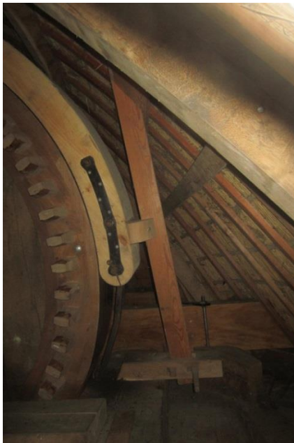
Afb.9 De lendestut zorgt ervoor dat het sabelstuk bij het lichten van de vang omhoog en niet teveel zijwaarts beweegt.
