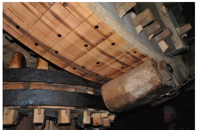
Afb.2 Het teenstuk van een stutvang (rechts). Om het bovenwiel zitten belegstukken . Hier wordt 'hout op hout' gevangen. (N.B. de stut is niet zichtbaar: zie afb. 6)
