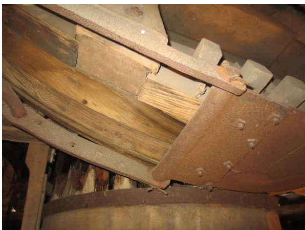
Afb.7. Een stalen bandvang . We zien het vanganker Er zijn géén belegstukken om het bovenwiel. Hier wordt 'staal op hout' gevangen.
