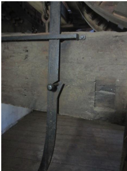
Afb.16 Een haak (of klink ) met klinkpen. De vang is gelicht. ('ligt in de haak')
