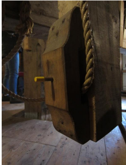
Afb.22 De trekvang aan de achterste hanger . Het touw loopt over een schijf en wordt omhoog getrokken.
