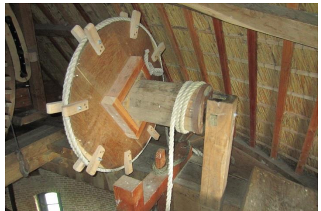
Afb.13 Een gaffelwiel-vang . Het vangtouw loopt om het gaffelwiel . Rechts het binnenvangtouw .
