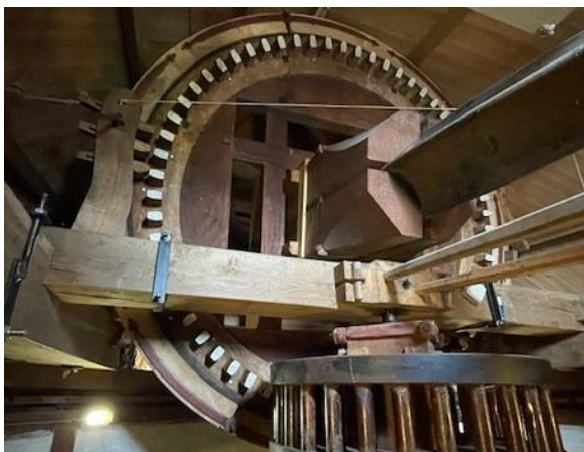
Afb.1 Een Vlaamse vang met vijf vangstukken , verbonden door losse maanjizers .
