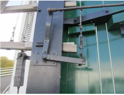
Een regelbord in een fok met hefboom, gewicht, veer en klepstang.
