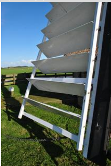
Zelfwichting. Rechts de treklat om de klepjes te bedienen.
