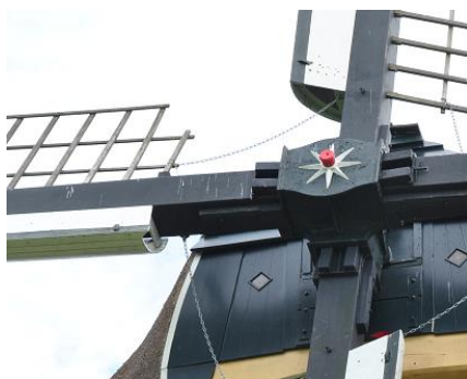
De spleet- of half-Dekkerwiek. De voorkant als Oud-Hollands windbord, achterkant gebogen als een fokwiek
