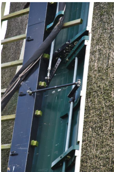
Een remklep in een fok. De trekstang is zichtbaar: die wordt bediend via een zwichtring achter de askop.
