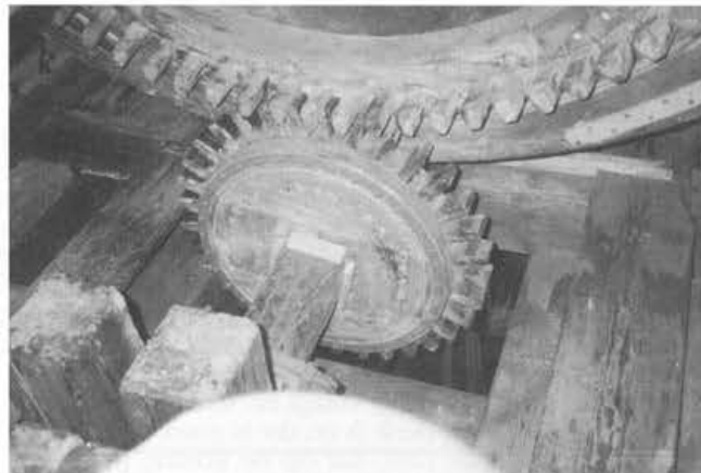
Het hier getoonde varkenswiel is het krukwiél van de Eenhoorn, direct aangedreven door het bovenwiel.
