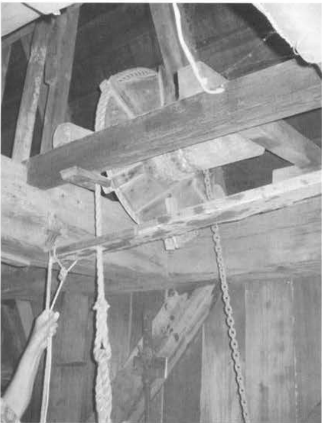
Bediening van de ijzeren bandvang met een gaffelwiel
