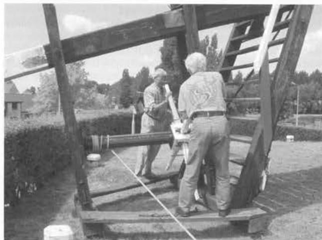
Het is zwaar kruien met een klein windkoppel.
