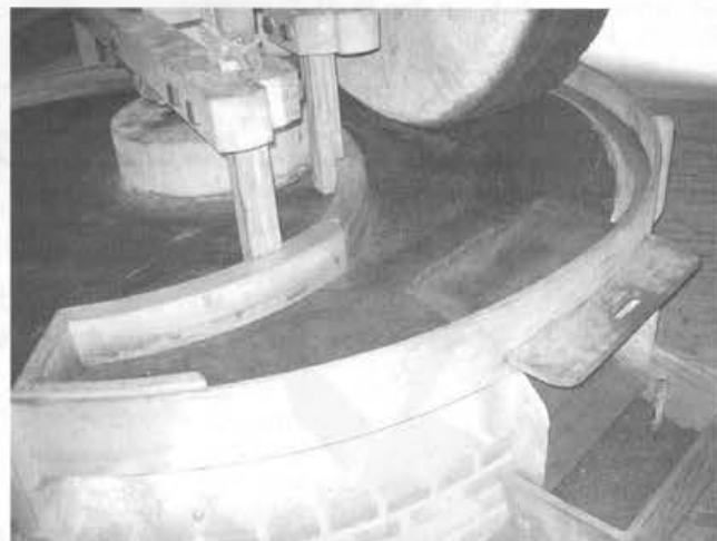
De legger van de pletterij met de strijker en de schuif in de kuip met er onder de meelkist.
