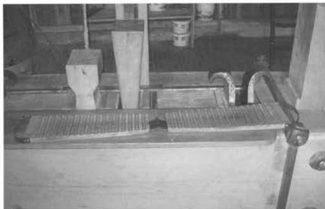
Het slagblok met daarin de laad en op de voorgrond de houten schooi.
