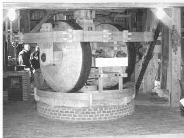
De pletterij met kantstenen en het doodbed.
