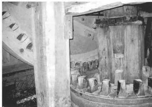
Het waterwiel met de bonkelaar op de koningsspij
