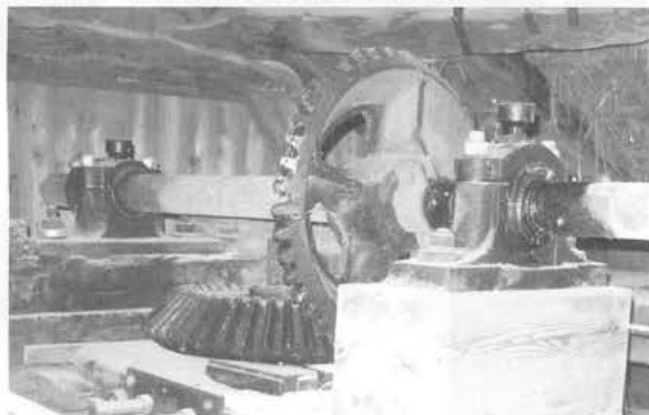
De haakse aandrijving voor de diverse in de molen opgestelde apparatuur.
