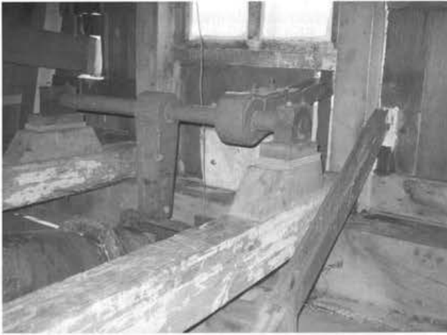
Hefboom voor zelfzwichting en instelling v.d. kleppen.
