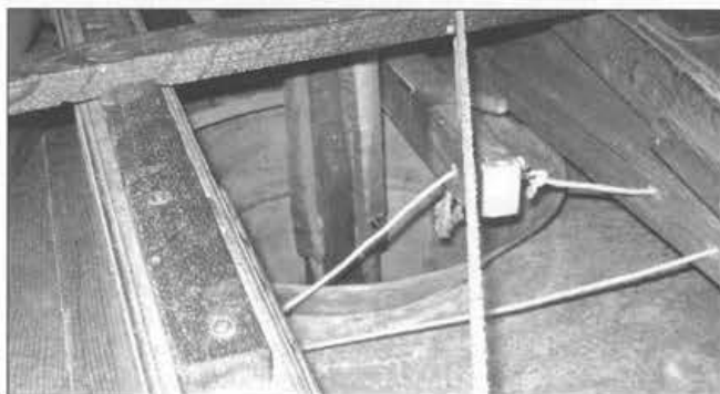
Een royale trechter vangt het graan op en voert het in het kropgat
