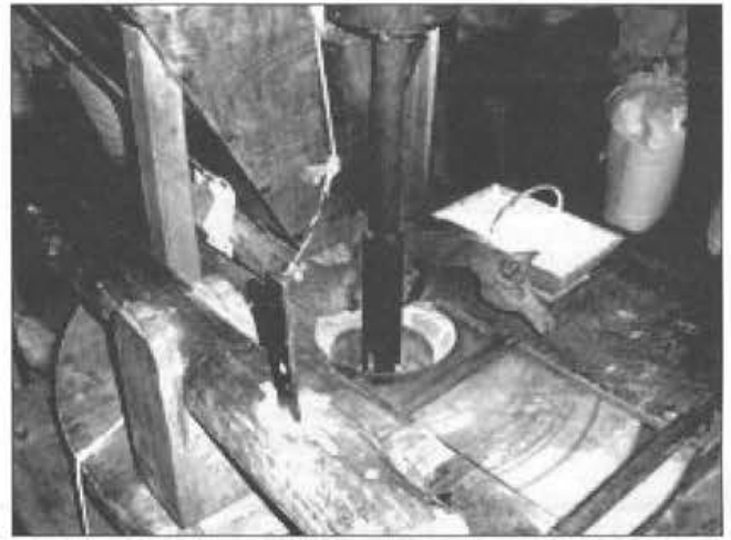
Het koppel stenen, de schuddebak met paardekop en links een deel van het lichtwerk.
