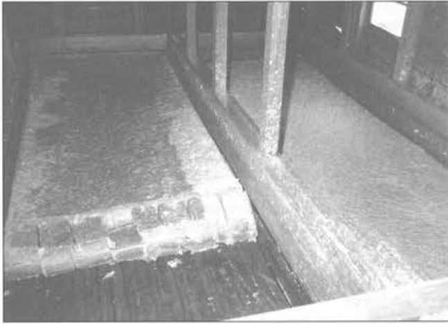
Na bewerking in de maalbakken wordt de stof afgelaten naar de verzijskasten.
