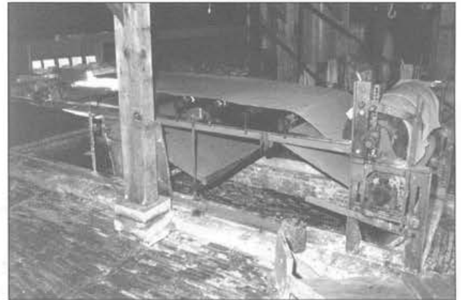
De papiermachine uit 1877, nu elektrisch aangedreven in plaats van de verwijderde stoommachine
