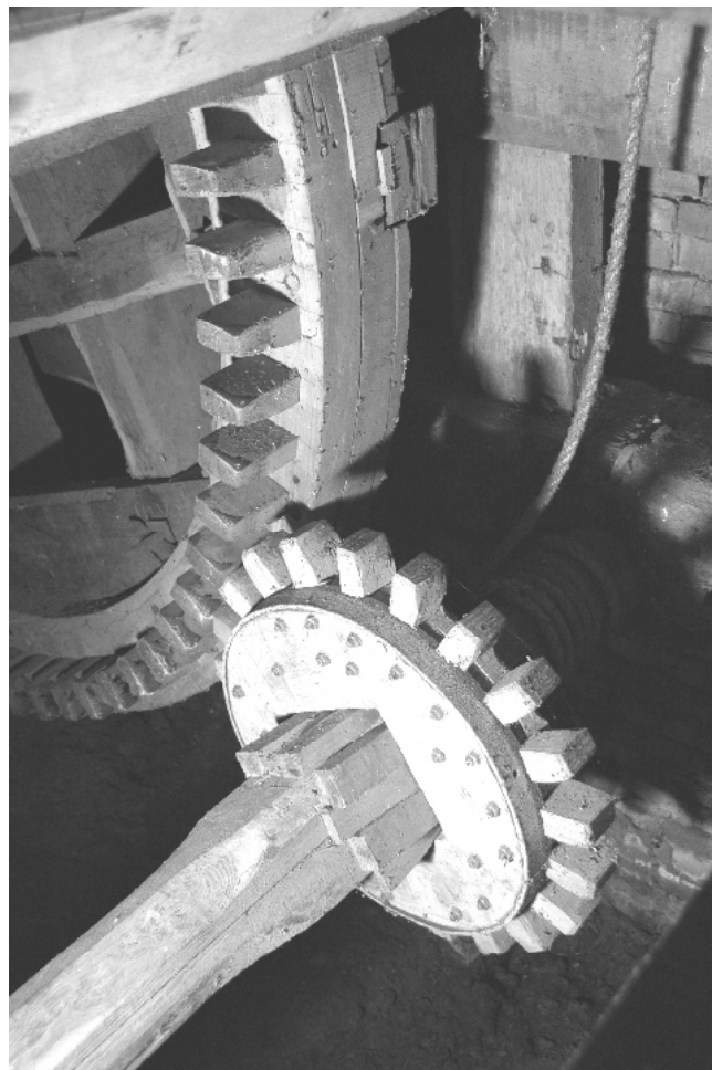
De tussenas voor het derde koppel stenen, de veelal genoemde kreupelmolen. Deze aandrijving kan vrij gezet worden van het waterwiel door de lagering achter het kamwiel iets te verschuiven.
