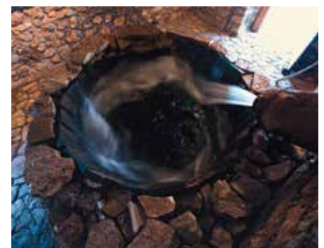
Bovenaanzicht van de vollerskuip. Let erop dat het water aan de zijkant inspuut en zo de kolk op gang brengt (foto museum)
