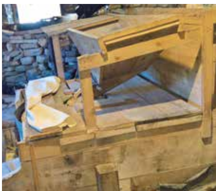
Balkje naast de kuip (bij de losse wiggen) is de licht. Dit bedient het lichtwerk onder de bolspil/schoepenradas.
