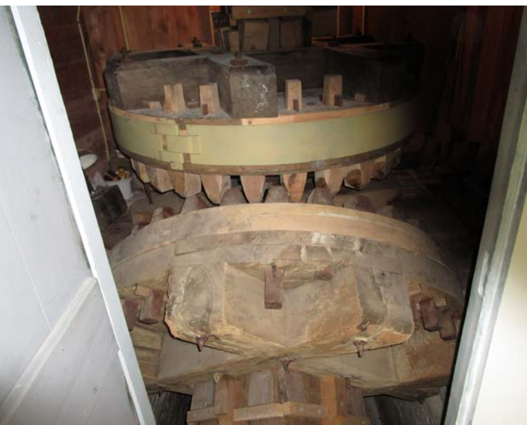
De kammen van de vijzelwielen lopen superlicht en zullen niet slijten
