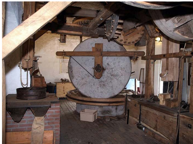
Enkelwerkse olieslagwerk in de Napoleonsmolen
