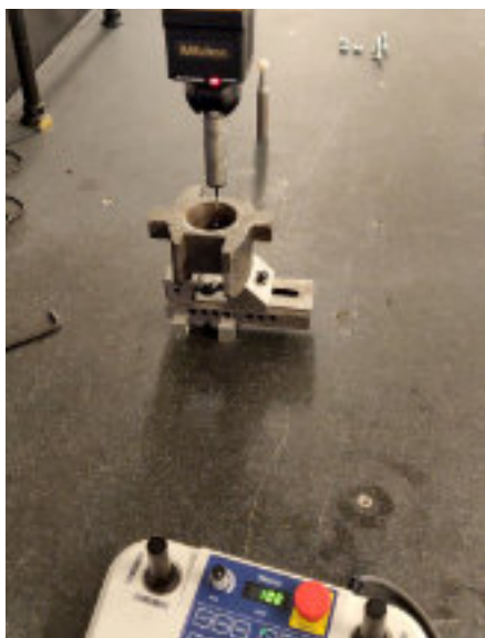
Afb. 3. Het inmeten van de oude binnenrijn door de firma Den Ouden.
