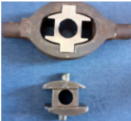
Afb. 4. Boven: de buitenrijn met de nieuwe binnenrijn, onder: de oude beschadigde binnenrijn
