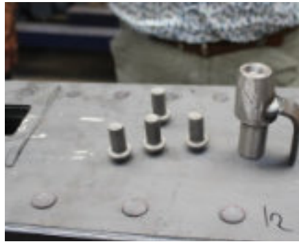
Afb 9. Rechts een dopper met links daarvan vier klinknagels.
