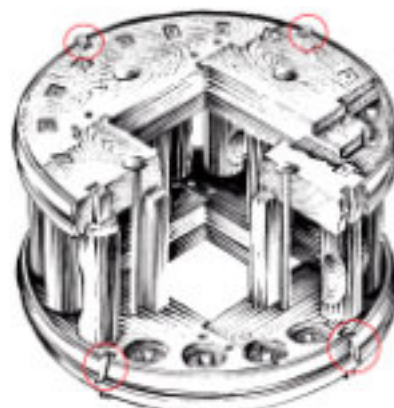
Afb. 2. Tekening van een schijffloop uit het boek Molenschiifwiel van Anton Sipman. Te zien is dat de stalen banden zowel boven als onder worden geborgd door vier zogenaamde klissen.
