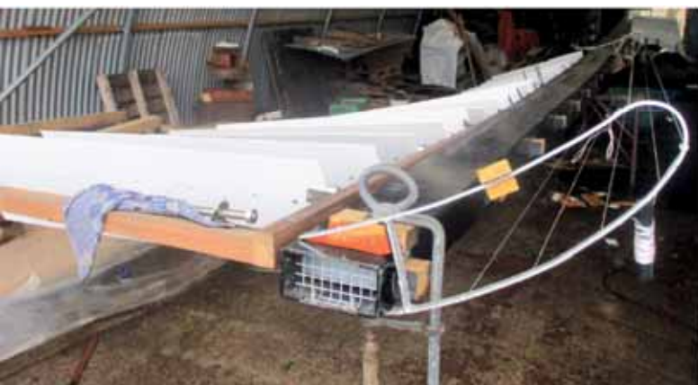
Afb. 3. De zelfzwichting op de hekszijde is voorlopig gemonteerd. Eén profiel is geplaatst.
