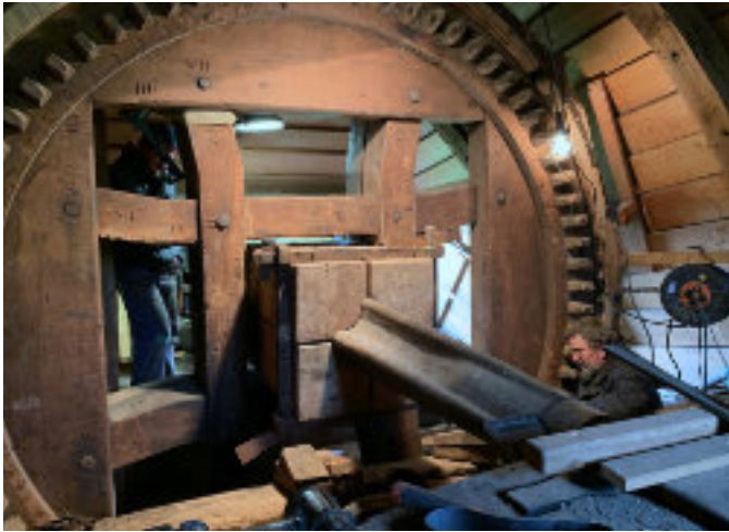
5. Het bovenwiel is nog heel. Let op de geknikte kruisarmen
