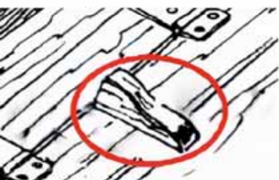
Afb 13. Een stutklamp verhindert dat een luik helemaal openklapt
