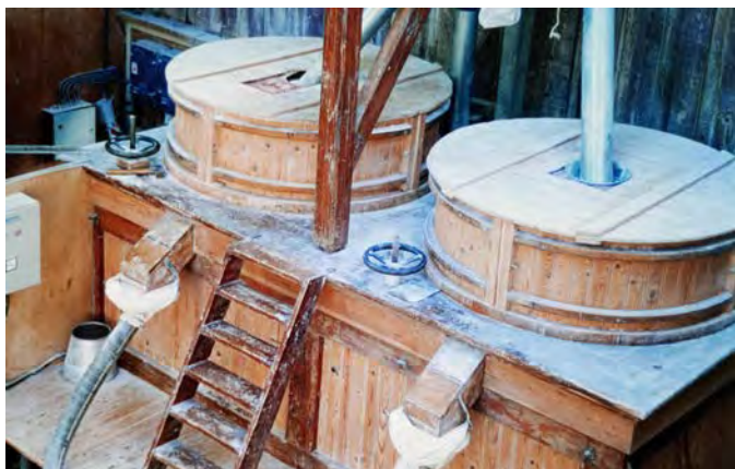
2 koppels 16der blauwe stenen zonder schuddebakken, boven de toevoerpijpen zat een verdeelklep.
