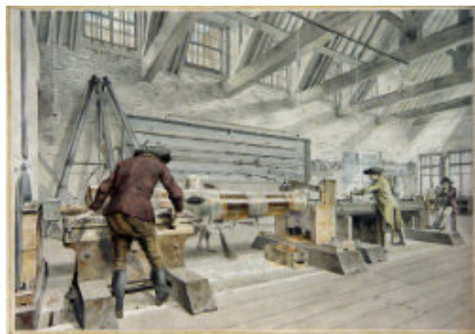
Afb. 3. Jan Verbruggen maakte ongeveer 1778 met behulp van een camera obscura deze tekening van het afdraaien en uitboren van massief gegoten stukken in de Woolwich Royal Brass Foundry.
