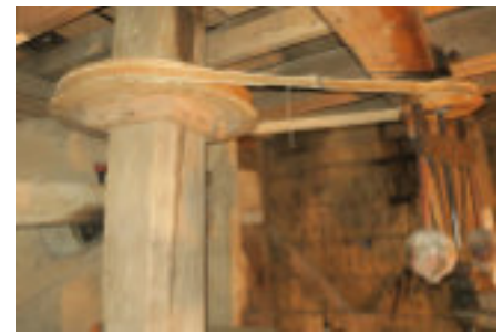
Aandrijving via de koningsspil Warkense molen
