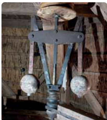
Duwregulateur Bouwjaar 1878 Aandrijving via de koningsspil
