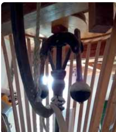
Duwregulateur Bouwjaar 1863 Herbouwd in 1959 / 1995 Aandrijving via de bolspil
