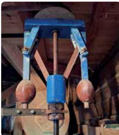
Duwregulateur Bouwjaar 1867 Aandrijving via de bolspil
