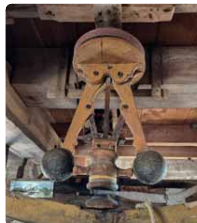
Houten trekregulateur Bouwjaar 1904 Herbouwd in 2007 Aandrijving via de bolspil
