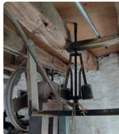
Trekregulateur Bouwjaar 1845 Aandrijving via de koningsspil
