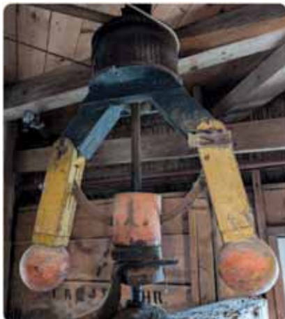
Houten trekregulateur Bouwjaar 1855 Aandrijving via de bolspil
