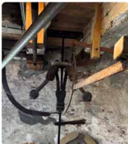
Trekreguleteur Bouwjaar 1896 Aandrijving via de koningsspil
