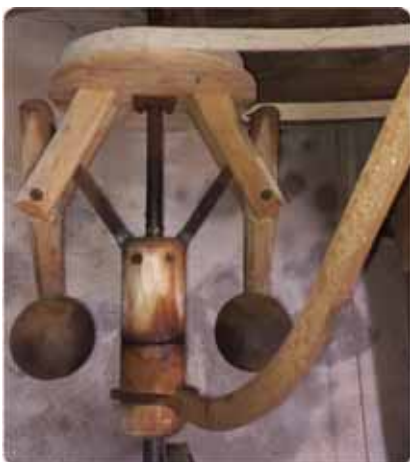
Houten duwregulateur Bouwjaar 1832 Aandrijving via de bolspil
