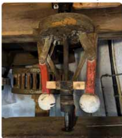
Houten duwreguleteur Bouwjaar 1890 Aandrijving via de koningsspil
