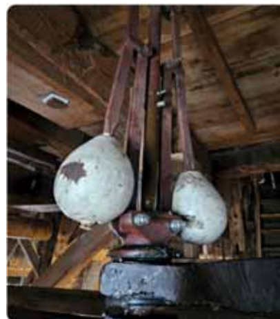
Trekreguleteur Bouwjaar 1722 Aandrijving via de koningsspil
