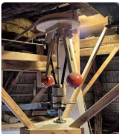
Trekreguleteur, Bouwjaar in Bovenkarspel 1849 Origineel in 1630 langs de Zaan Herbouwd in 2019 / 2021 Aandrijving via de bolspil
