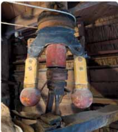
Houten duwregulateur Bouwjaar 1855 Aandrijving via de bolspil
