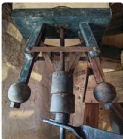
Duwregulateur Bouwjaar 1818 Aandrijving via de steenspil
