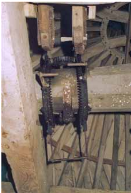
Foto 4: Het differentieel met daarboven de bedieningsarmen.
