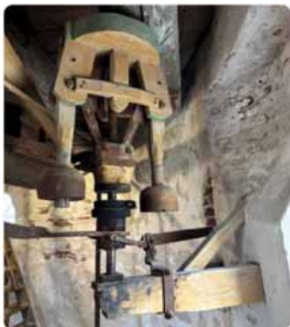
Houten duwreguleteur Bouwjaar 1896 Aandrijving via de steenspil
