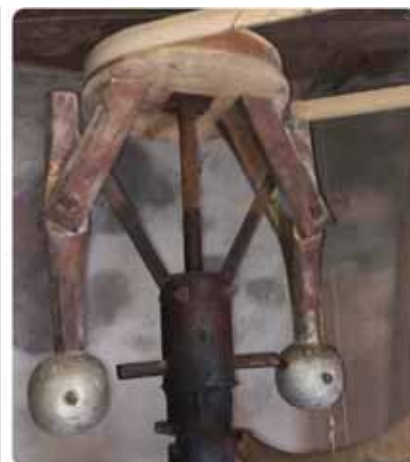
Duwregulateur Bouwjaar 1832 Aandrijving via de bolspil
